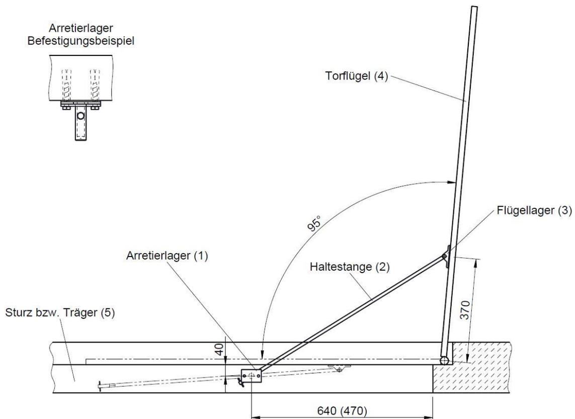
Die Haltestange wird auf der gesamten Lauffläche selbsttätig durch das Arretierlager gefettet. Ein Nachfetten des Torfeststellers sollte mindestens einmal jährlich erfolgen.
